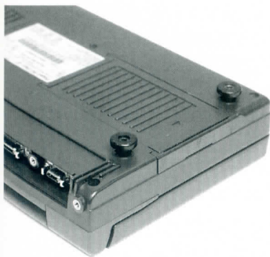
写真10 Poqet PC Plusに付いている「謎」の足。足付きのバームトップ機というものはじめてである
