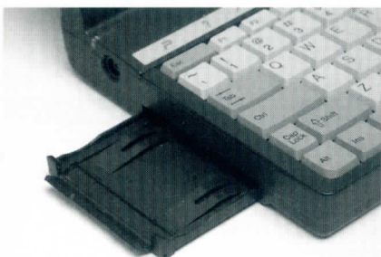
写真12 モデムカードのように「ブタの尻尾」が出るカードに対応するため、各トレーの側面部分がフタになっている
