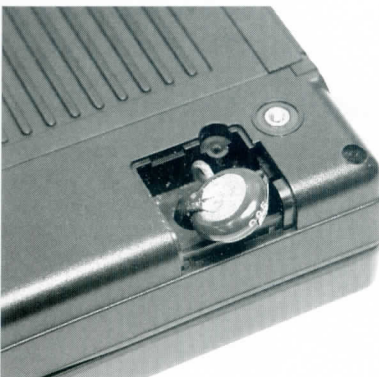
写真13 内蔵メモリをバックアップするNi-Cdバッテリーは、なんと、粉を吹いており、これ以上なく死んでいた……
