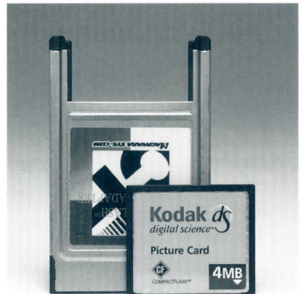
写真17 Kodak Picture Card 4MBというCOMPACT FLASH カード (SanDisk 1997年製造) を、COMPACT FLASH CARD ADAPTER を使って接続したのも動作する
