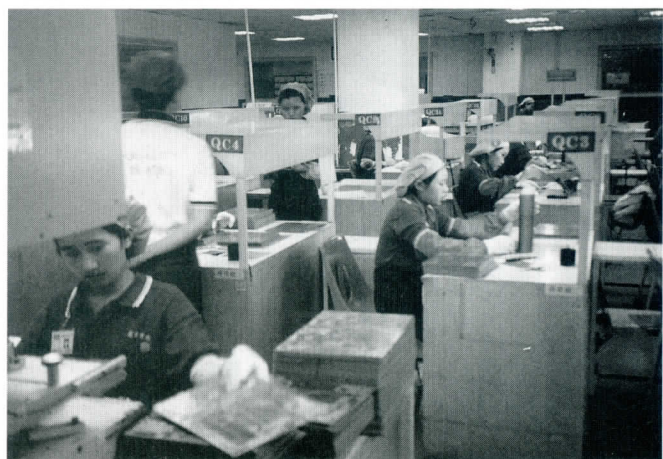
⑫目視による検査工程——でき上がったプリント基板に異常がないかどうかの最終チェックを行っている
