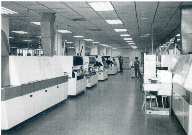
26 深圳石川電子有限公司の自動表面実装装置——松下製実装装置「Panaset」がずらりと並んでいる
