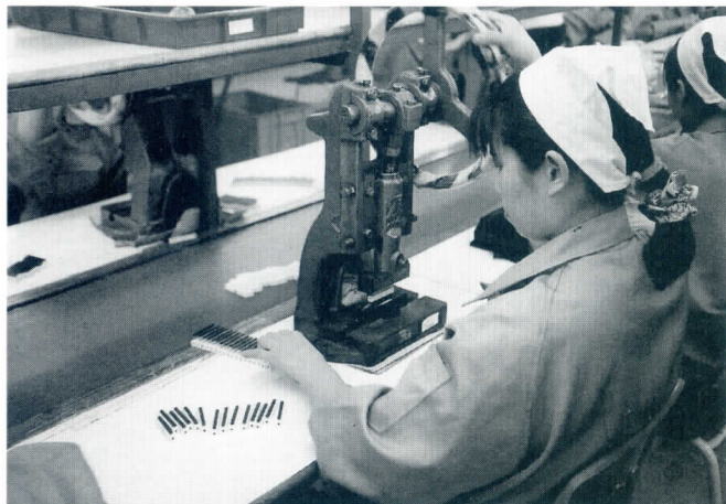
(16) 部品組み立てラインの一部——ここでは、マザーボード上に実装されるIDEやFDDのソケットをつくっている。ソケットのピンヘッダ部分を、1個1個手作業で組み立てている
