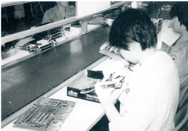
35 マザーボード裏面の余分なワイヤをカット——部品のリード線など、飛び出たワイヤをニッパで切断している
