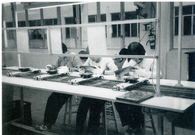
30 目視によるチェック工程——自動実装装置による部品のマウントが正常に行えたかどうかを、目視によってチェックしている
