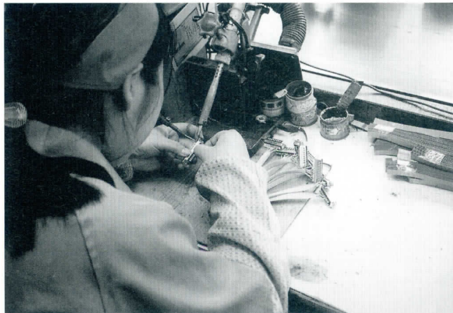
21) パラレルコネクタケーブル製作工程(その1)——フラットケーブルをパラレルコネクタ(D-Sub25ピン)に手作業で半田付けしていく
