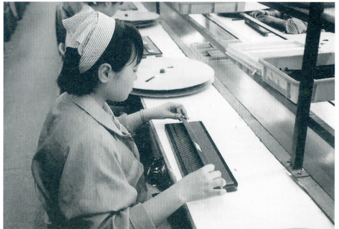
24) ISAバススロットの接点部分の組み立て工程(その2)——挿入した接点部分を切り離す作業を行う。金属の板で前後にしごいて、分離させる
