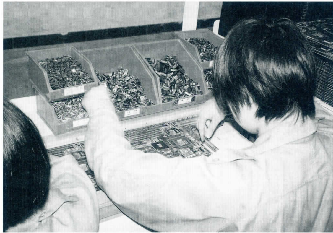
32 パーツ類の実装——チップセットなどの実装が終わると、次は各種コネクタやジャンパピン、レギュレータ用ICなどの実装工程に移る。これは、手作業でパーツをマザーボードに入れているところ
