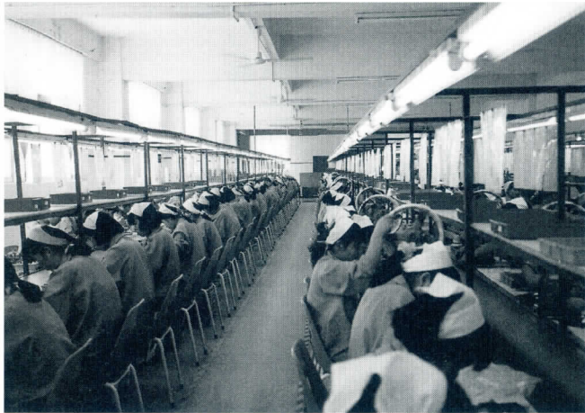
25 鉄騰電腦配件廠のライン風景——ベルトコンベアを挟んで2列に作業員が並び、製造していく
