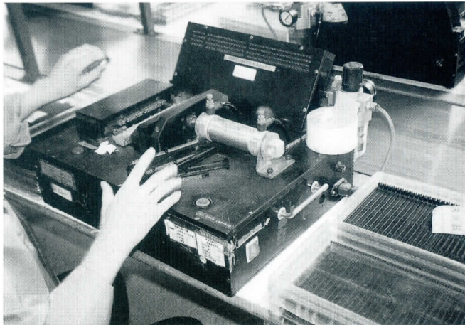
(20) DIMMコネクタの製品検査工程——専用の治具を使用し、組み上がったコネクタに欠損がないかどうかをチェックする。検査は簡単で、1個1個コネクタを治具に挿入し、前面パネルのLEDが点灯すればOKだ
