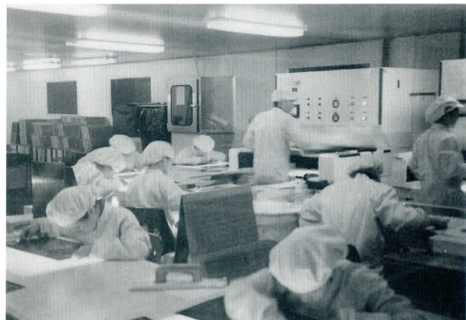
⑪目視による検査工程——目視により、プリントされた回路に断線や接触異常などがないかどうかを検査している。この工程には、視力のいい人が採用されている
