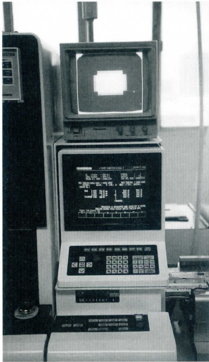
28 新型 Panasonic の制御卓画面——実装中のデバイスがCRTに表示される。1個のデバイスの実装時間は、きわめて短い
