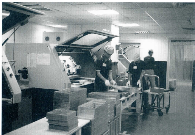
⑦プリント基板製造工程の一部——ここでは、でき上がったボードを1枚ずつカットしている。手前に整然と積まれているのは、カッティングされたあとに出た廃材。廃材も、このようにきちんと処理されていく
