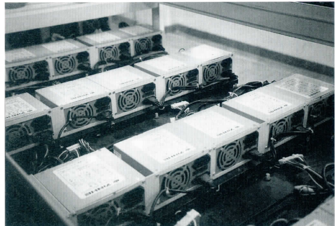
38 バーンイン用に用意されたAT電源の列——一度に多くのマザーボードのバーンインを行うため、電源の台数も半端ではない
