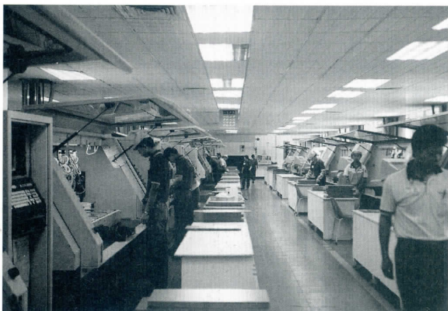
⑧プリント基板に部品を実装するための穴を空ける工程——全自動の穴空け機が両側に並んでいる
