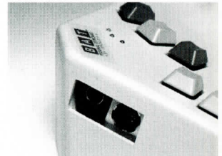
写真12 BATキーボードのケーブル接続用ポート
