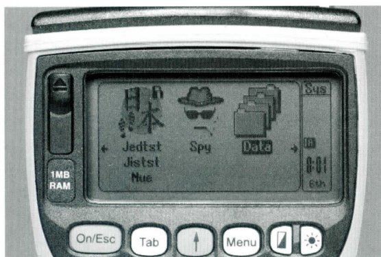
写真5 240×100ドットの解像度を持つWorkaboutのLCD画面
