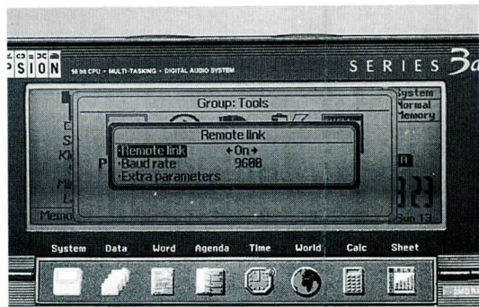
写真17 Psion本体でのRemote linkの設定画面。Psion+Lキーを押すことによって、シリアルインターフェイスのON/OFFと、接続時のボーレートを設定できる
