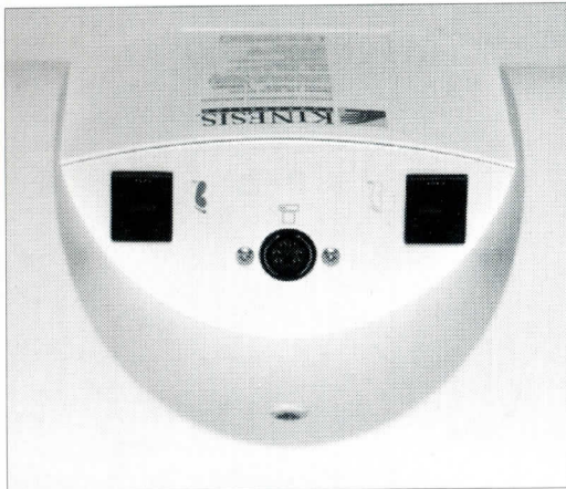
写真4 D-SubミニDINコネクタを中心に、フットスイッチを付けるためのコネクタが左右に配置されている
